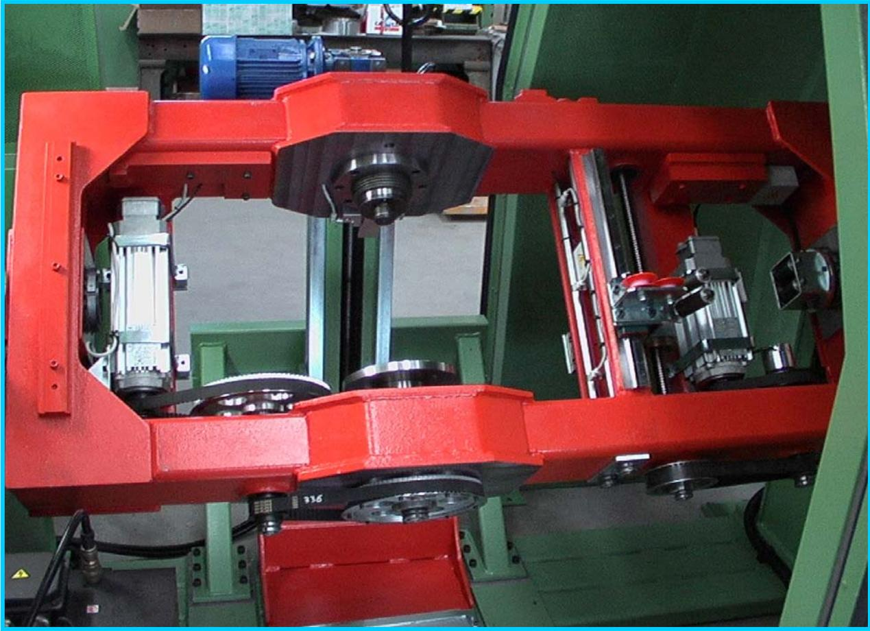
Geeignet fuer die Verseilung von empfindlichen Produkten wie Lichtwellenleiter, abgeschirmte Kabel mit Glas oder Kupfer geflechtet und isolierte P.T.F.E.– Kabel. Der Inline-Betrieb mit Rueckdrehungsablaeufen erlaubt es eine flexible Linie zu erreichen welche ausser einer hohen Verseilqualitaet auch sehr hohe Produktionsleistungen erlaubt im Gegensatz zur ueblichen Korbverseilung.
